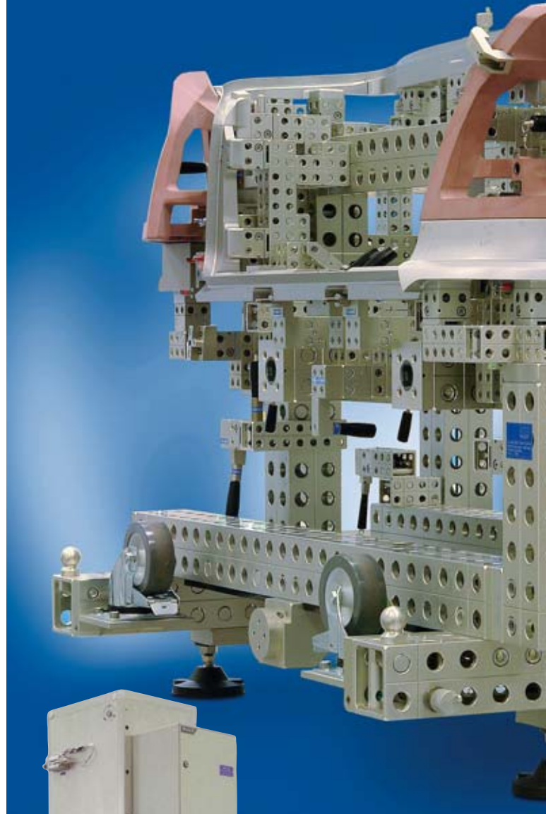
◀ Analysevorrichtung für die Bebaubarkeit von Unterbodenverkleidung. Luftgelagert, höhenverstellbar, rotierend, elektrisch gesteuert
