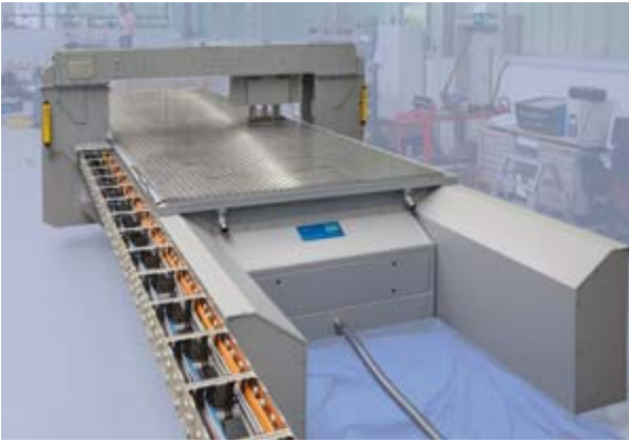
▲ Vakuumschließvorrichtung mit eigenem Portal und integriertem, hydraulischem Andruckverfahren (2000 kg)
