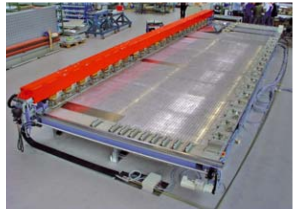
▲ Spannvorrichtung für zylindrisch, vorgewalzte Hautfelder - Teile werden angedrückt, flachgerollt und mit Vakuum, hydraulischen und mechanischen Spanner gespannt
