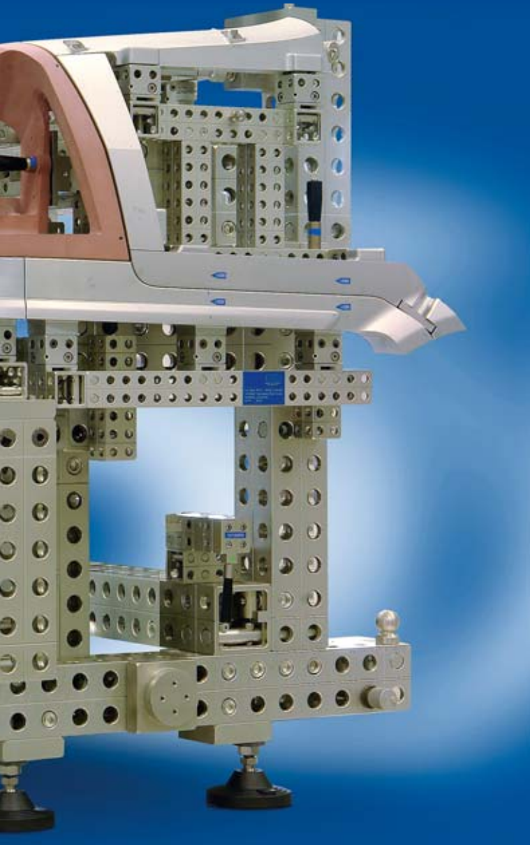
▲ Hochstabiles, mobiles, modulares Kubing aus ca. 80% Standardelementen ermöglicht Änderungen in Teilbereichen und ist wiederverwendbar für zukünftige Modelle
