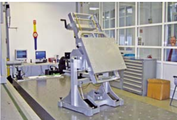
▲ Vakuumschließvorrichtung mit eigenem Portal und integriertem, hydraulischem Andruckverfahren (2000 kg)
