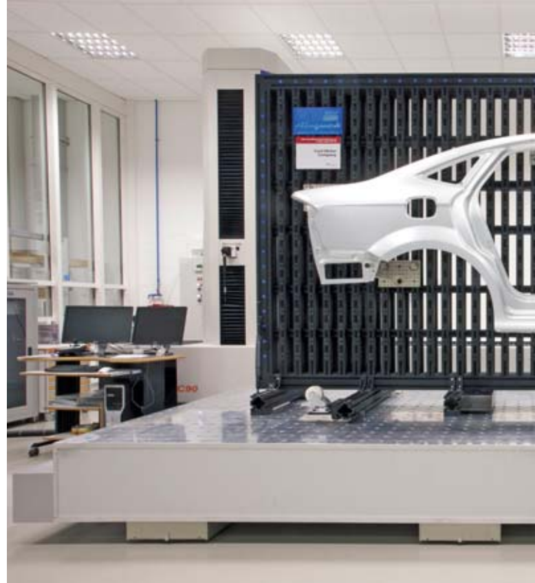
Horizontale Grundplatte mit Luftkissen, Antrieb manuell, mit Versorgungsleitung für Druckluft
