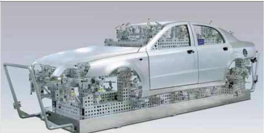
Horizontale Sandwichplatte mit Meisterbock-Aufbau
