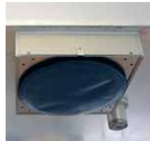
Unterseitig an der Sandwichplatte angebrachte Luftlager-Kassetten
