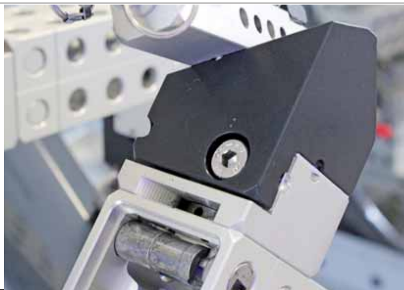
Anwendungsbeispiel Shimblock-oberteil (Orange) angeschrägt mit aufgesetzter Rasterschellen-Spanneinheit (Blau)
