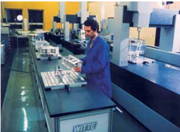
Rüsttischanlage für 3 KMM mit verfahrbarer Übergabebrücke
